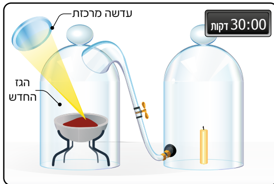
איור 6: חימום האבקה האדומה גורם לשחרור גז בלתי מזוהה שעובר אל הפעמון שבו נמצא הנר
